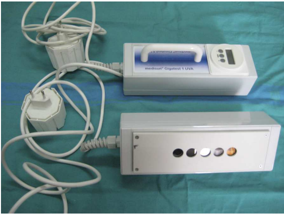
Figura 4 Lámpara fluorescente de mano portátil. Lámpara de espectro continuo ( PLS-special ) de 9 vatios con filtro integrado para el espectro de emisión, con 5 spots de 5mm que emiten el 7%-34%-63%-85%-100% del espectro en UVB o en UVA (Gigatest, Medisun, Francia) y, por tanto, determinar la dosis de exposición (en \text{j}/\text{cm}^2 ) según el tiempo de contacto cutáneo.
