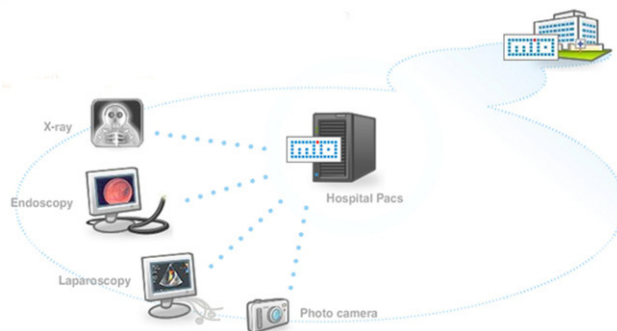
Figura 1 Representación esquemática del funcionamiento de un Picture Archiving and Communication Systems multidepartamental.
